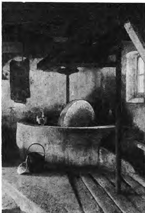
FIG. 854. — Moulin à écraser les olives pour l'extraction de l'huile.
