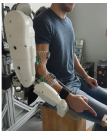
Tâche de pointage réalisée avec l'exosquelette ABLE hébergé au CIAMS
