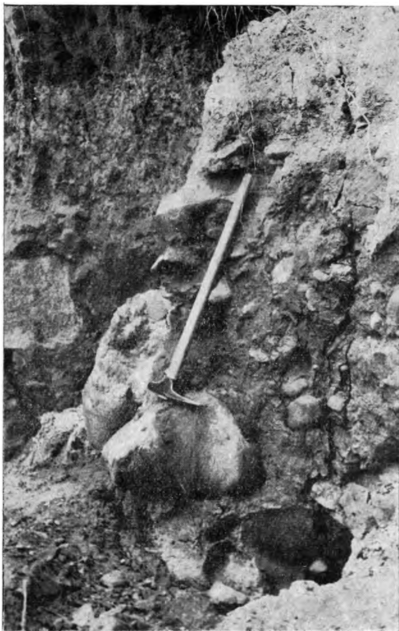
Фиг. 22. Деталь верхней морены в Петровском «гравийном» карьере (обн. 46). Морена сложена коричнево-бурой супесью, набитой валунами разных размеров и пород (в отвале — гранитные и гнейсовые валуны диаметром до 1,5—1,75 м). Для масштаба — молоток с ручкой несколько длиннее 60 см. Вверху морены — норы ласточек
