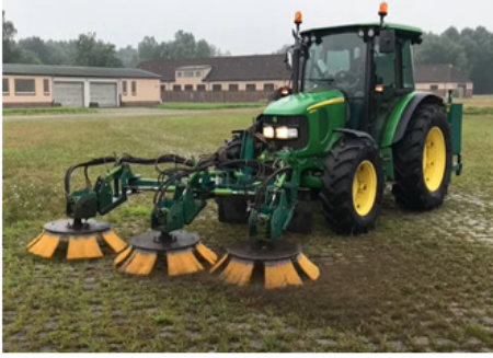
Görsel 7.7: Fırçalama makinesi ve tırmık ile yabancı ot kontrolü
