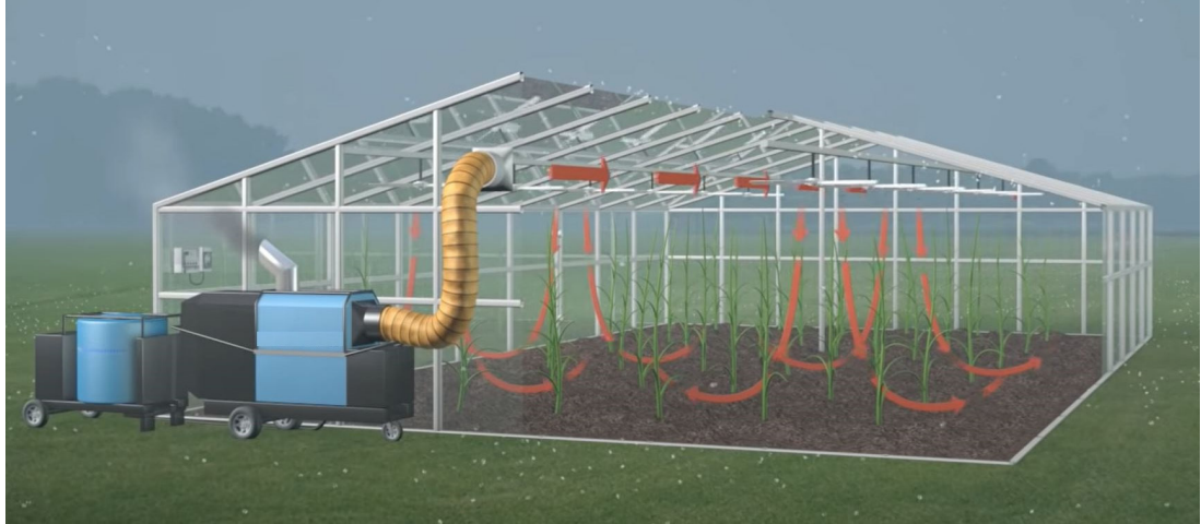
Görsel 4.19: Sera ısıtma sistemlerinde hava akım şeması
