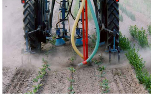
Görsel 7.7: Fırçalama makinesi ve tırmık ile yabancı ot kontrolü
