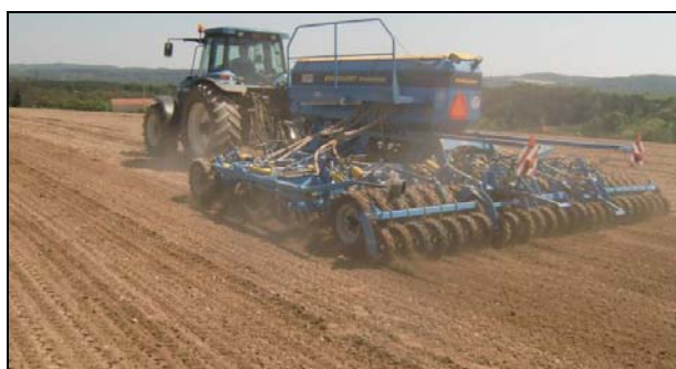
Secí stroj Farnet EXCELENT Premium nabízí výbornou kvalitu setí a vysokou produktivitu. Urovná povrch, zpětně utuží půdu a obnoví kapilaritu, vytvoří seťové lůžko a zajišťuje přesnou hloubku setí.
