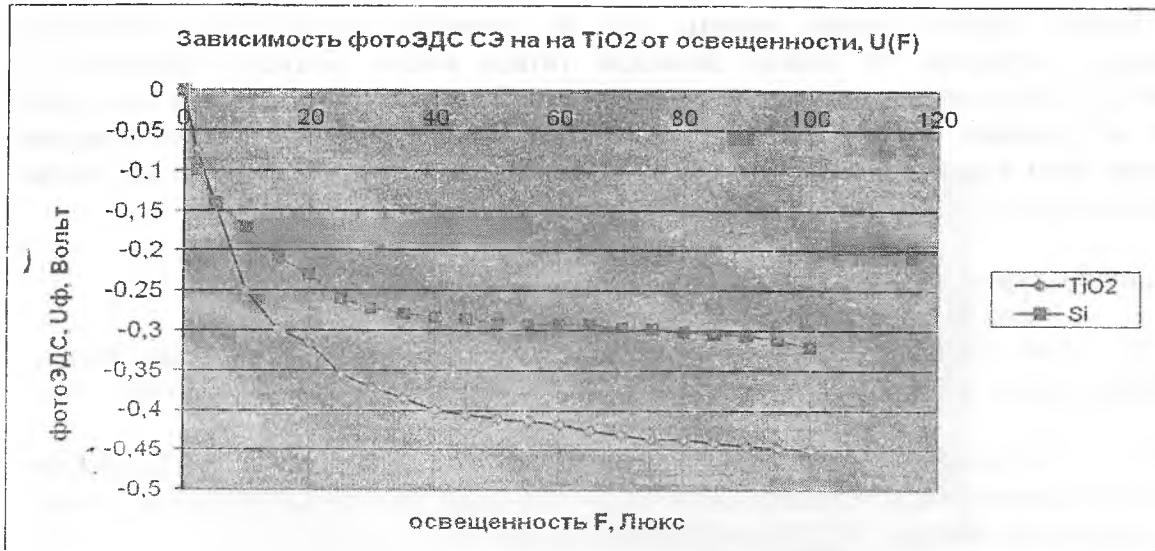
Рис.4. Зависимость фото ЭДС солнечного элемента на основе диоксида титана(о) и кремния (■) от освещенности её поверхности.
