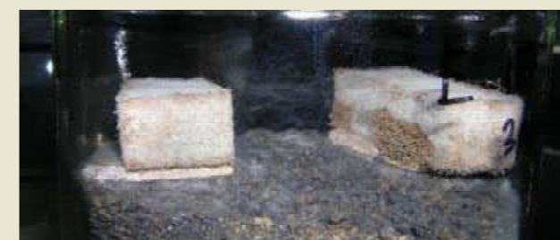
Blok-blok ujian tanpa Borogard ZB selepas didedahkan kepada kulat Test blocks without Borogard ZB after fungus exposure test
