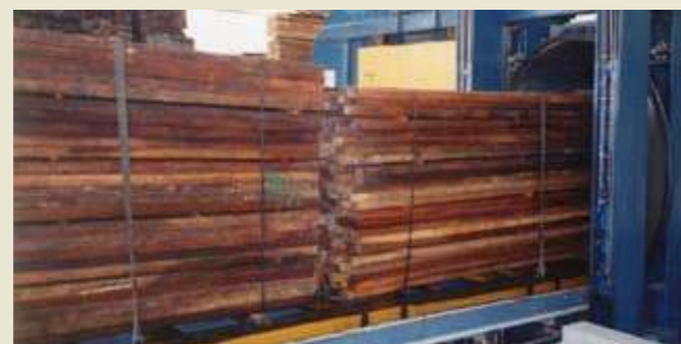
Kayu untuk rawatan LOSP Stack of wood ready for LOSP treatment
