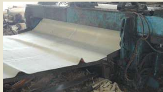
Penghasilan venir dengan pelarik tanpa spindel Veneer peeling using spindleless lathe
