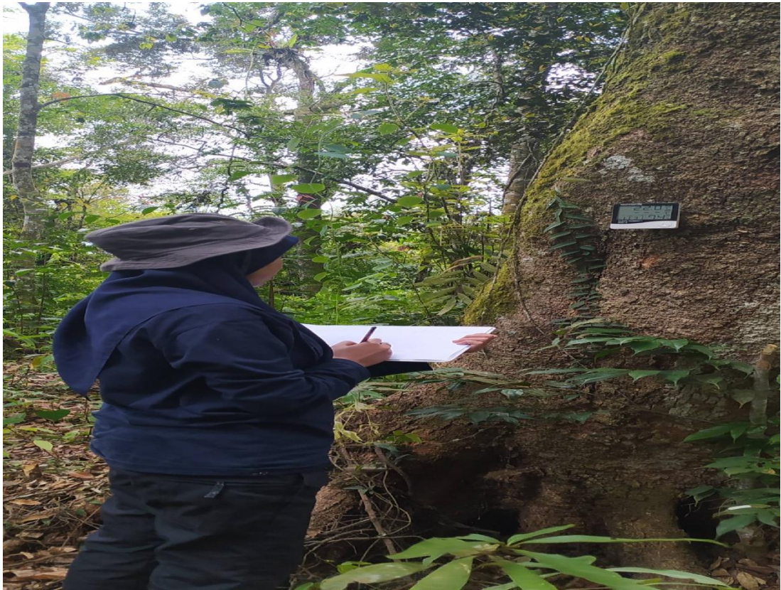
Melakukan pencatatan suhu dan kelembapan udara dengan Thermo-hygrometer
