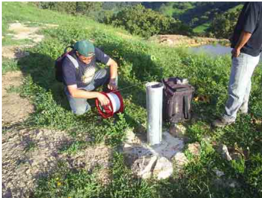
Fotografía IV.2.4-8 Medición de nivel en el piezómetro DH05-07 que se ubica en el sitio de la planta, en junio de 2005.
