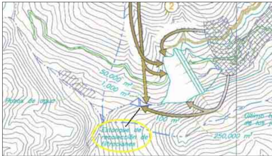
Figura II.1.5-5 Detalle del estanque de recolección de filtraciones.
