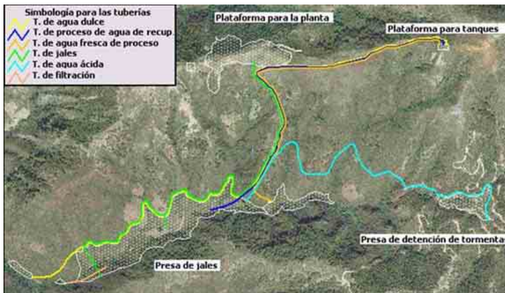
Figura II.1.5-8 Ubicación de las tuberías en el proyecto.
