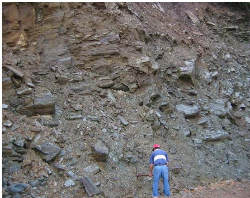
**Figura II.16. BANCO DE REVESTIMIENTO TIPO ESQUISTO (UNICO TIPO DE MATERIAL QUE EXISTE EN LA ZONA) UBICADO EN EL KM. 25+900 LADO DER. DEL MISMO CAMINO**
