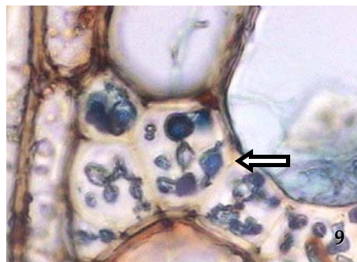
Figuras 8 y 9. Degradación gradual de la capa S 2 y lámina media de la pared celular en madera de Didimopanax atacada por hongos de pudrición blanca. Degradación de la madera de Ceiba sp. (testigos) por hongos de pudrición blanda en el campo Bochinche I. La flecha señala la presencia de cavidades en la capa S 2 de la pared celular.
