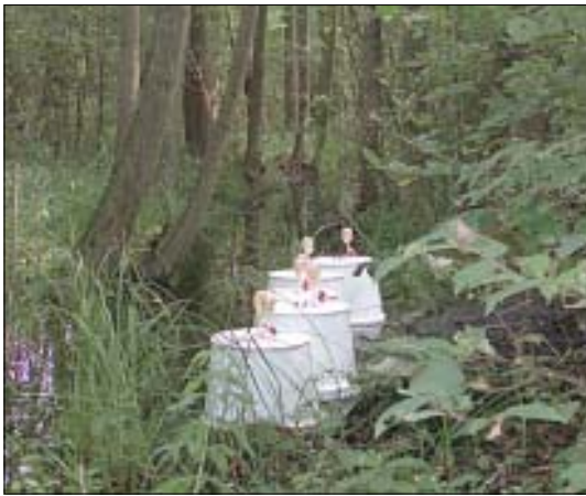
Abb. 3: Messung der Spurengasemission mit Hilfe von Gassammelhauben (closed-box-Methode) auf einer flach entwässerten Erlenbruchwaldfläche im Naturschutzgebiet der Gumnitz (Müncheberg/Ostbrandenburg)
