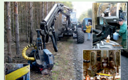
Umgerüsteter Harvester zur Stübenapplikation von Pilzpräparaten im Revier Schwarzhöhe, perforiertes Schwert, gefärbtes Biomatz Pg. Bar 1
