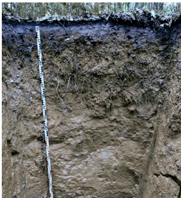
Abb. 2 u. 3: Braunerdssole aus Feinsand (li, unter Kiefer) bzw. Grobsand (re, unter Traubeneiche) mit unterschiedlicher Durchwurzelung bei geringen Nährkraftunterschieden im Altpleistozängebiet, nahe Doberlug-Kirchhain.
