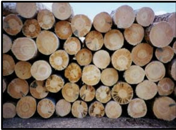
Trozos afectadas con mancha azul
