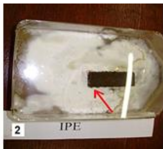
Obr. 2. Vzorek dřeva ipe s kapkami vody na povrchu hranolku (viz šipka) v kultivační baňce a vzorek dřeva po vyndání z baňky.
