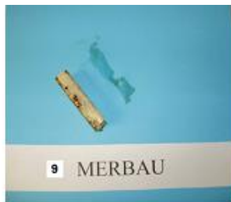
Obr. 3. Vzorek dřeva merbau pokrytý myceliem v kultivační baňce a po jeho vyndání z baňky jeho pokrytí slizem.
