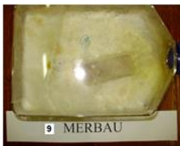
Obr. 3. Vzorek dřeva merbau pokrytý myceliem v kultivační baňce a po jeho vyndání z baňky jeho pokrytí slizem.
