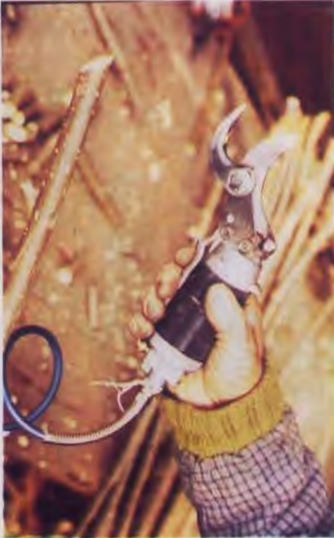
Şekil 37. Çelik kesimi için kullanılan pnömomatik makas
