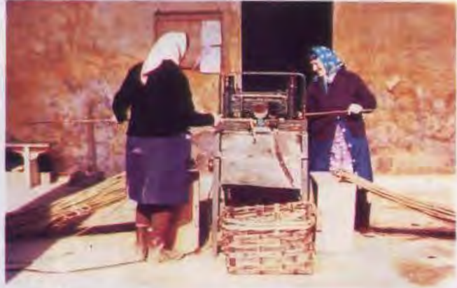
Şekil 38. Çelik kesim makinesi. İki işçi saatde takriben 2500 çelik kesebilmektedir.
