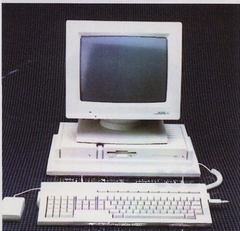
Oben: Das TT-Gehäuse bietet leider keinen sicheren Standplatz für den Monitor und ist so klein, daß es zu Platzproblemen mit Erweiterungskarten kommen wird. Mitte: Zusätzlich zu den vom STE bekannten Schnittstellen verfügt der TT über einen SCSI-Port und zwei weitere serielle Anschlüsse. Unten: Nach der Demontage diverser Abschirmbleche hinterläßt die TT-Platine immer noch einen sehr gedrängten und engen Eindruck.
