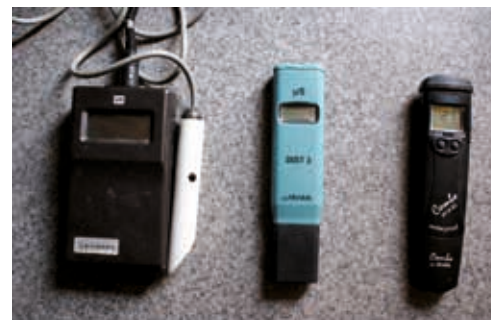
Die Abbildung zeigt diverse Geräte zur Messung: links Leitfähigkeitsmessgerät, Mitte Taschenmessgerät für die Leitfähigkeit, rechts Kombigerät für Leitfähigkeit, pH-Wert und Temperatur sowie Konzentrationsangabe in g/l.
