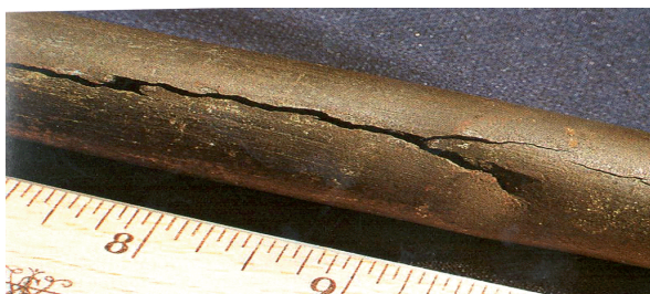
Рис. 1. Результат воздействия водорода на обычную сталь
