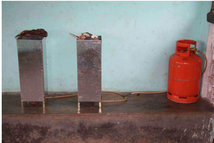
Photo du séchoir De Kesel (2001) ; ici fonctionnant au gaz et en double capacité.
