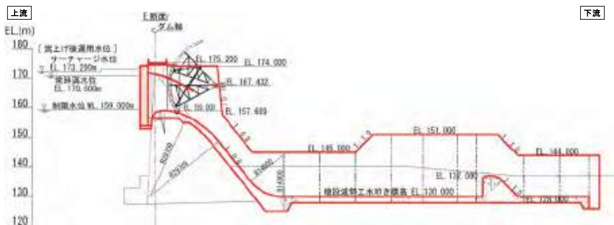
図 2.3-8 増設洪水吐き縦断面図
