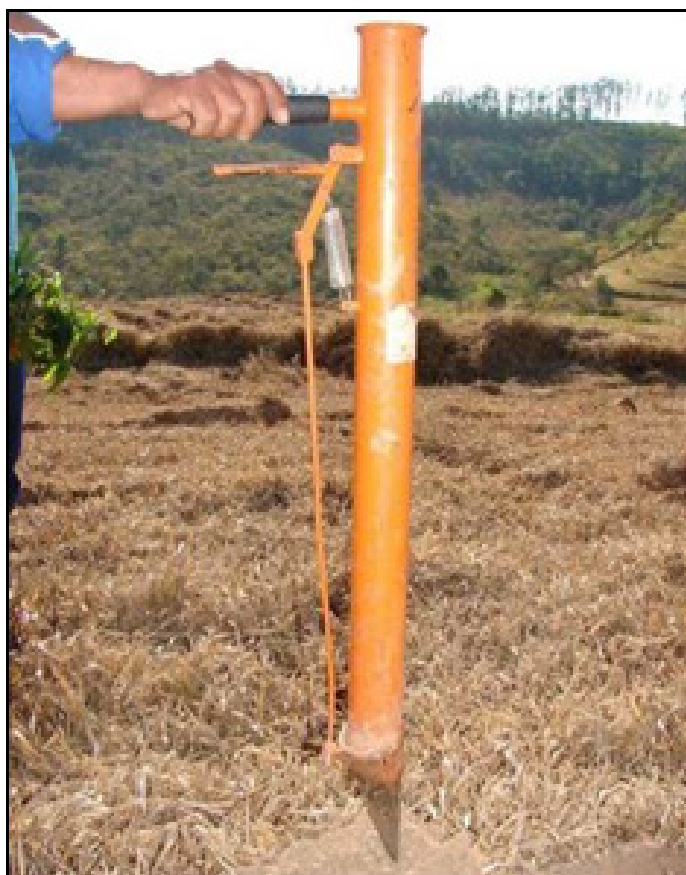
Figura 23 – Plantadora manual de mudas
