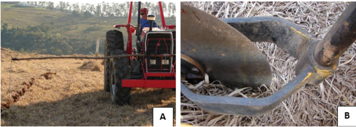
Figura 18 – Uso de um cabo de madeira com uma corrente em sua extremidade para a orientação da subsolagem em relação à linha adjacente (A) e disco de corte do subsolador cortando a palhada já seca (B).
