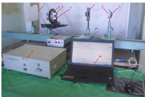
Рис.1. Фото лабораторного стенда для калибровки солнечных датчиков. 1- параболическое зеркало, 2-галогенная лампа, 3- диафрагма, 4-поворотный держатель солнечных датчиков на столике, 5-образцовый солнечный датчик, 6-поверяемый солнечный датчик, 7-экран, 8-стабилизатор напряжения, 9-АЦП, 10-компьютер
