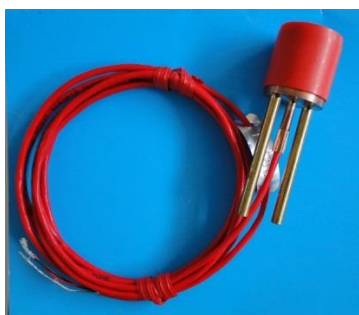
Рис.1. Медный стержневой микро радиометр для измерения плотности высококонцентрированного солнечного потока
