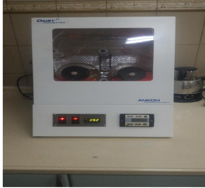
Şekil 2.3. Daisy inkübatör cihazında in vitro gerçek sindirilebilirlik analizi.
