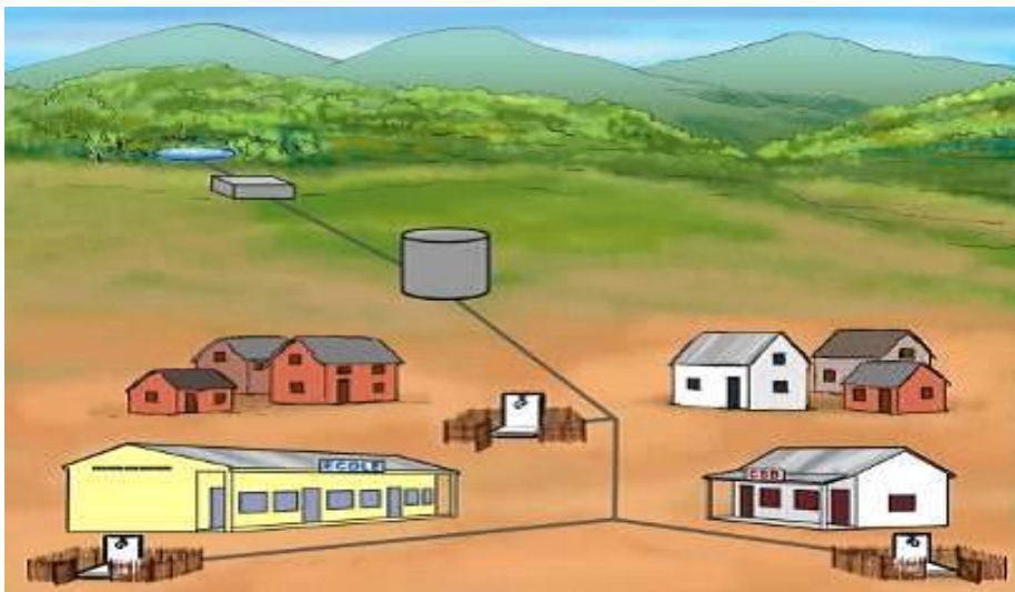
Figure 56 : Système d'adduction d'eau potable gravitaire à plusieurs bornes-fontaines pour plus 250 personnes
