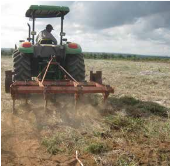
Figura 4. Escarificador com sete hastes de 35 cm.
