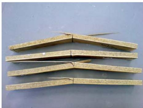
(C) corpos de prova ensaiados de *Medium Density Particleboard* + *Dendrocalamus asper*
