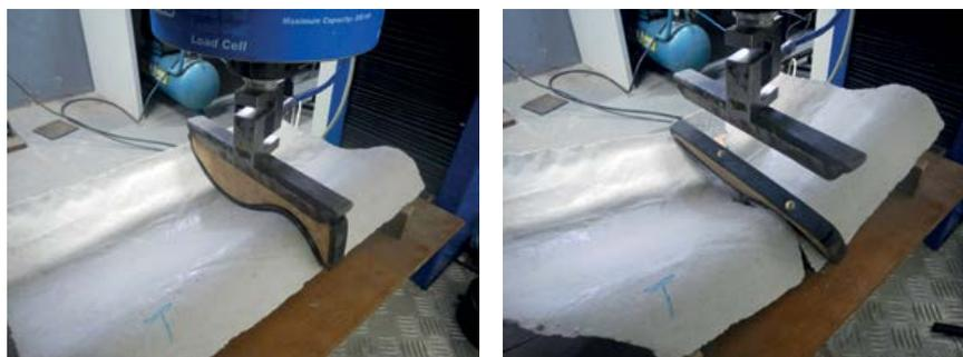
Figura 6. Ensaio de flexão aplicado à telha ondulada
