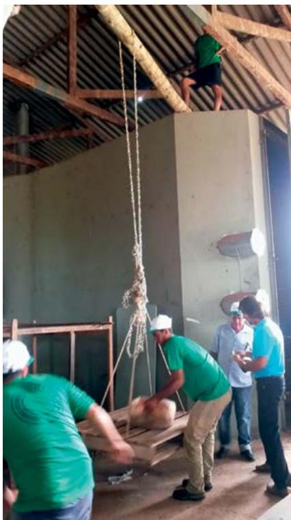
Figura 9. Teste de carga realizado em dezembro de 2013, com quase 700 kg sustentados por um bambu
