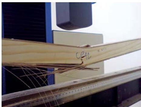
(D) ensaio de resistência à flexão de corpo de prova de *Pinus taeda* com reforço de *Guadua angustifolia*
