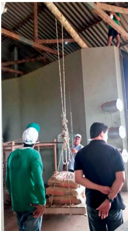
Figura 10. Para o teste de carga, foram usados 10 sacos de cimento de 50 kg, somados ao peso de três homens
