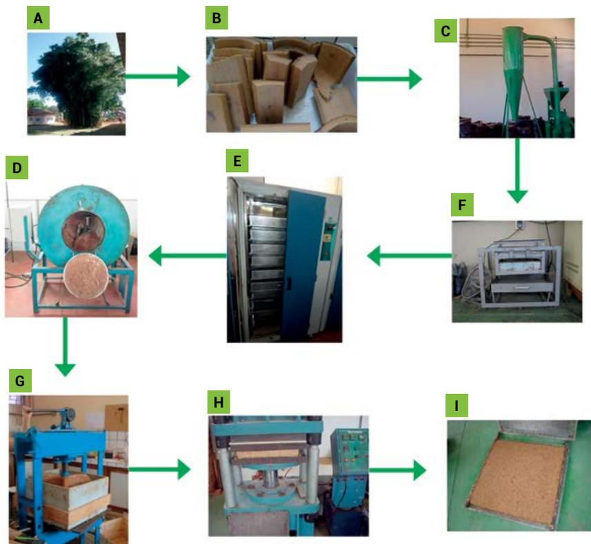
Figura 1. Esquema de produção de painéis de bambu em escala laboratorial (A) Bambuzal; (B) Bambu cortado em serra circular; (C) Geração de partículas de bambu em moinho martelo; (D) Classificação das partículas de bambu para a face e para o miolo; (E) Secagem das partículas de bambu; (F) Aplicação de adesivo em encoladeira do tipo tambor rotativo; (G) Pré-prensagem e formação do colchão; (H) Prensagem a quente; (I) PAINEL DE BAMBU PRONTO
