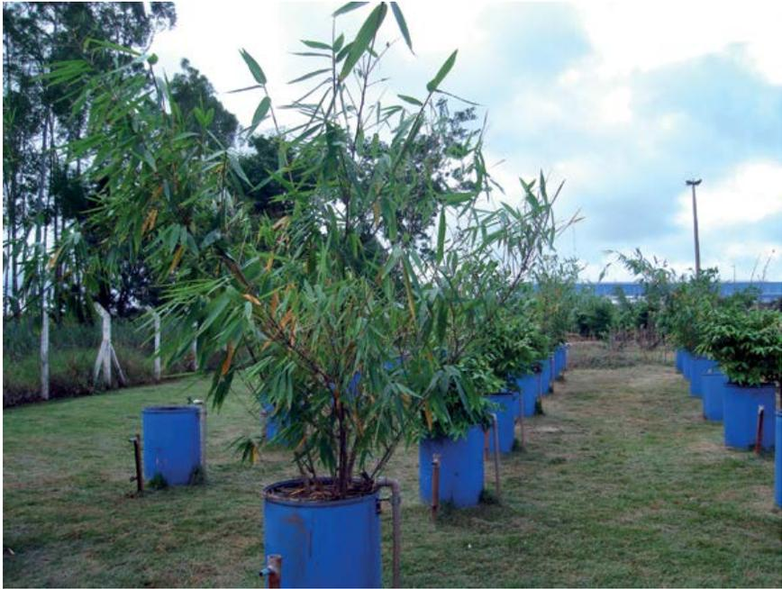
Figura 2. Vista parcial da estação experimental de tratamento de efluente líquido industrial utilizando espécies de bambu
