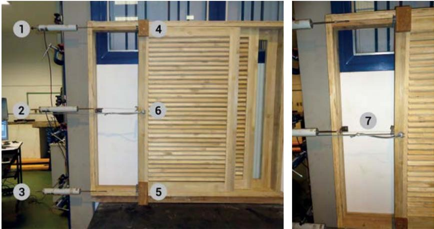
Figura 2. Sistema de aquisição de dados (computador); pontos 1, 2 e 3 de medição de deslocamentos com defletômetros; pontos 4 e 5 de fixação; ponto 6 de aplicação da carga; ponto 7 de deslocamentos no plano da folha, com dois cantos imobilizados, máximo deslocamento (carga máxima) de 60 kg
