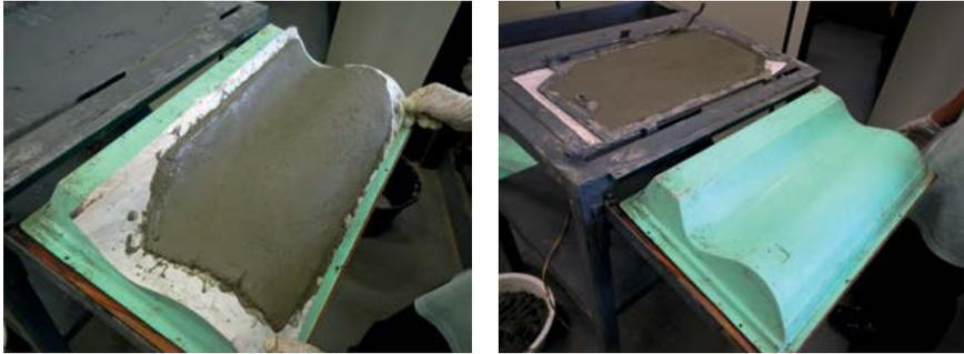
Figura 4. Equipamento utilizado na produção de telhas onduladas
