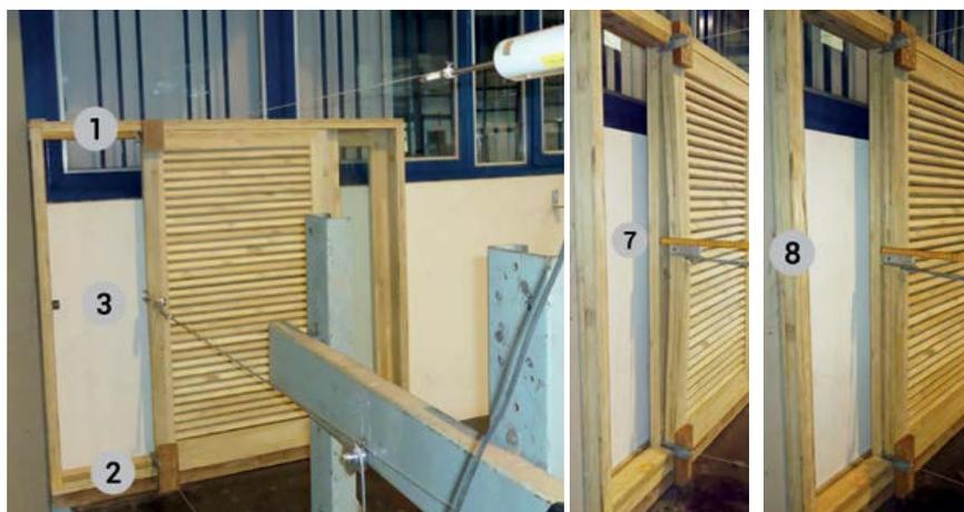
Figura 3. Sistema de fixação e imobilização da esquadria com aplicação da carga para medição da flexão; pontos 1 e 2 de fixação; ponto 3 de aplicação da carga; pontos 4, 5 e 6 de medição de deslocamentos com defletômetros; ponto 7 de deslocamentos no plano da folha, com dois cantos imobilizados, máxima deformação (carga máxima) de 60 kg; ponto 8 de deslocamento residual após carregamento máximo
