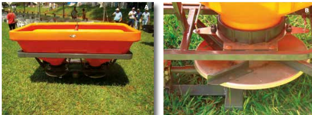
Figura 4. Semeadora a lanço (A) e detalhe do distribuidor centrífugo com dois discos (B).
