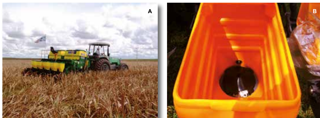
Figura 2. Semeadora de precisão (A) e detalhe do depósito de sementes (B).
