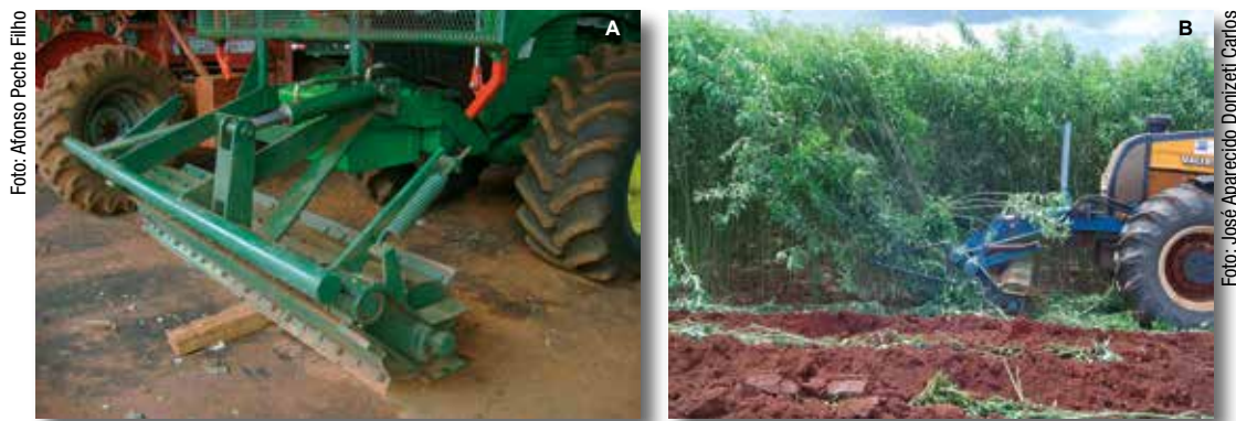
Figura 10. Rolo-faca frontal (A) e seu funcionamento acamando crotalária-júncea ( Crotalaria juncea L.) (B).
