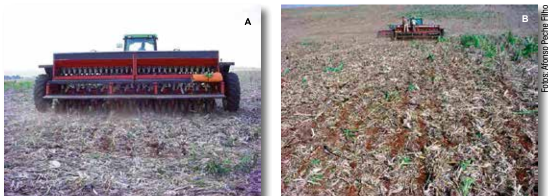
Figura 3. Modelo de semeadora de fluxo contínuo (A) e detalhe do campo após a semeadura (B).
