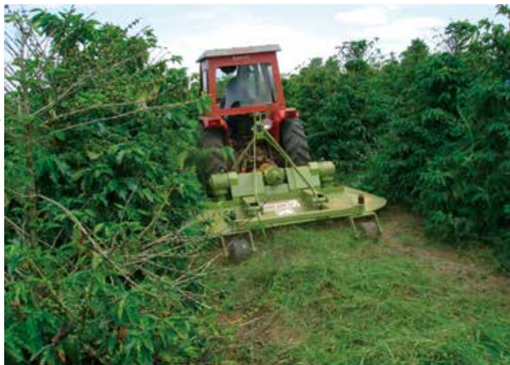
Figura 14. Modelo de roçadora para pomares: fragmentos grandes.
