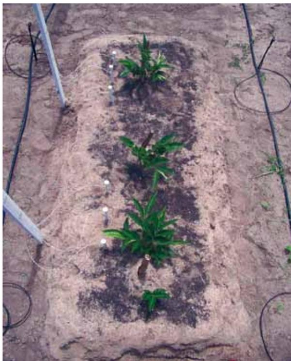
**Figura 3.** Baterias de tensiômetros de mercúrio instalados em três profundidades.
