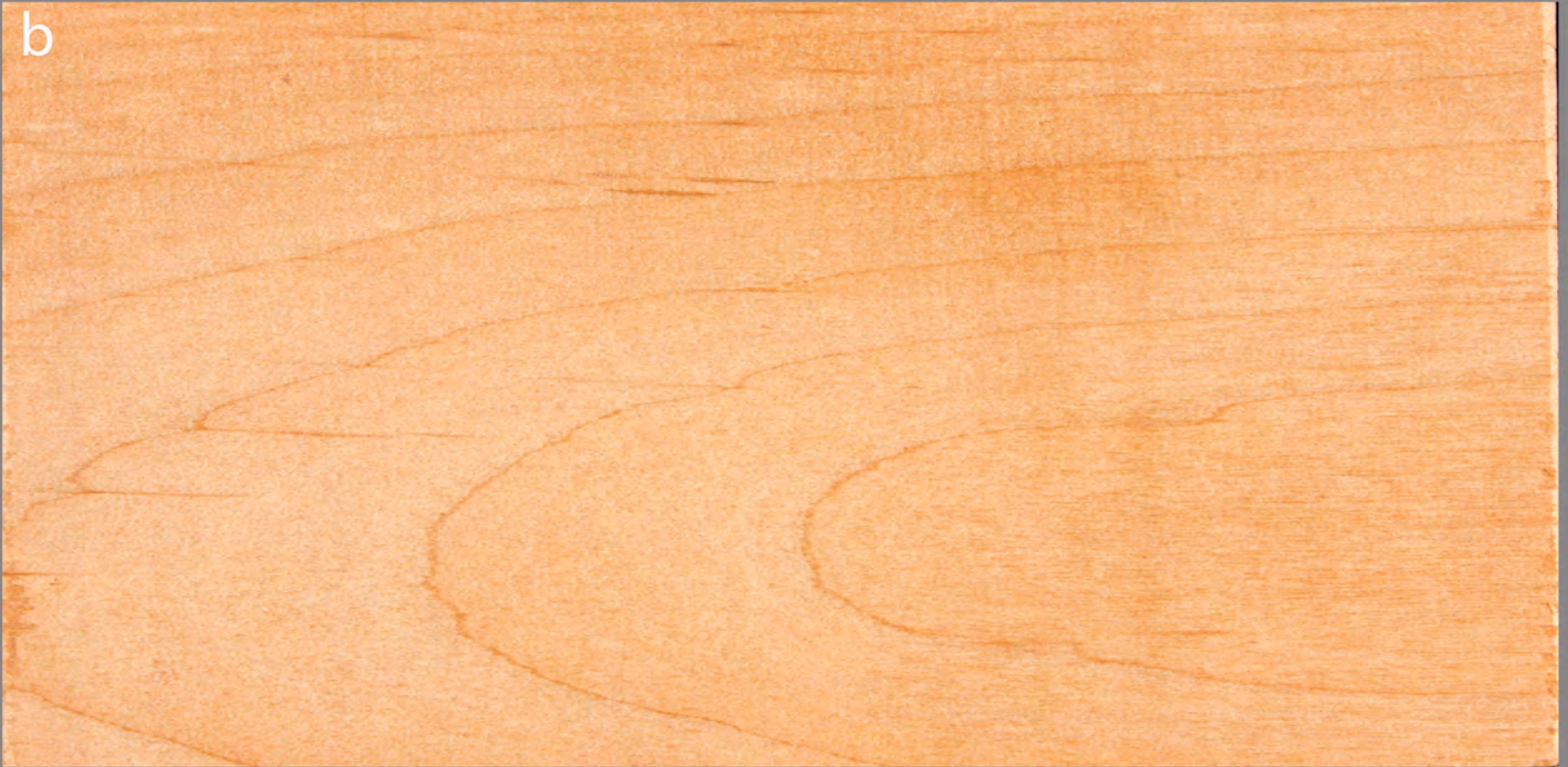
ALDER. ( Alnus rubra .) a).- corte radial. b).- corte longitudinal. c).- corte transversal.
