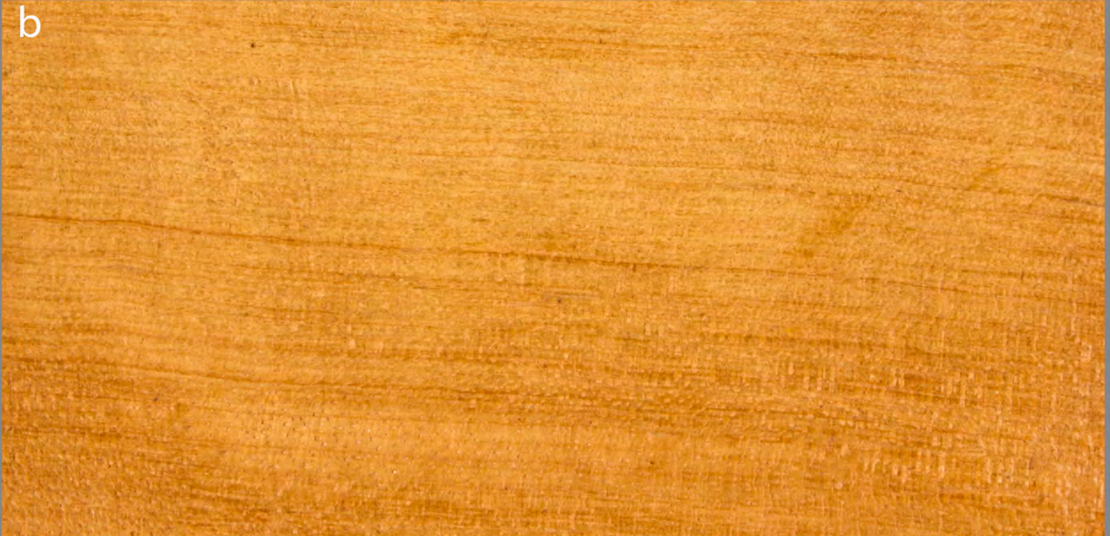
LAUREL. ( Nectandra ambigens .) a).- corte radial. b).- corte longitudinal. c).- corte transversal.
