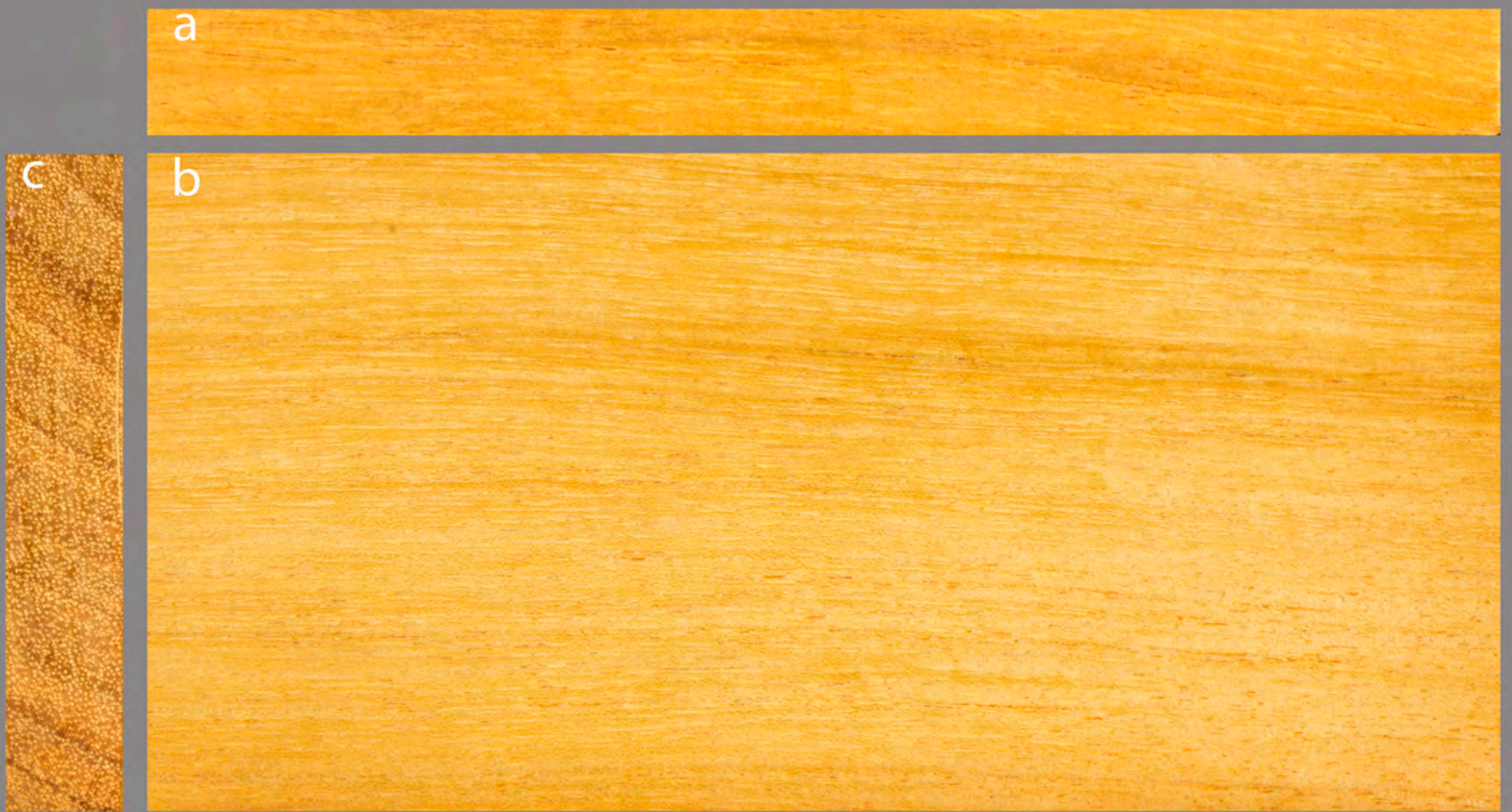
PALO AMARILLO. ( Diphysa robinoides .) a).- corte radial. b).- corte longitudinal. c).- corte transversal.
