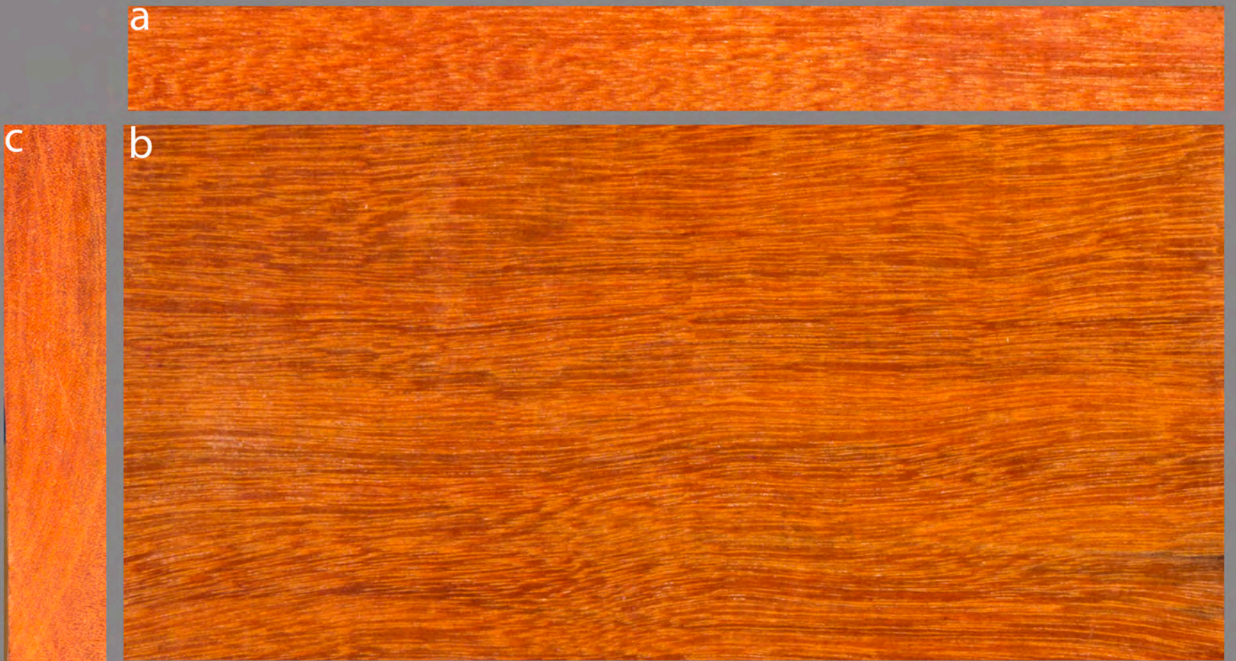
CHACTE VIGA.( Caesalpinia platyloba .) a).- corte radial. b).- corte longitudinal. c).- corte transversal.
