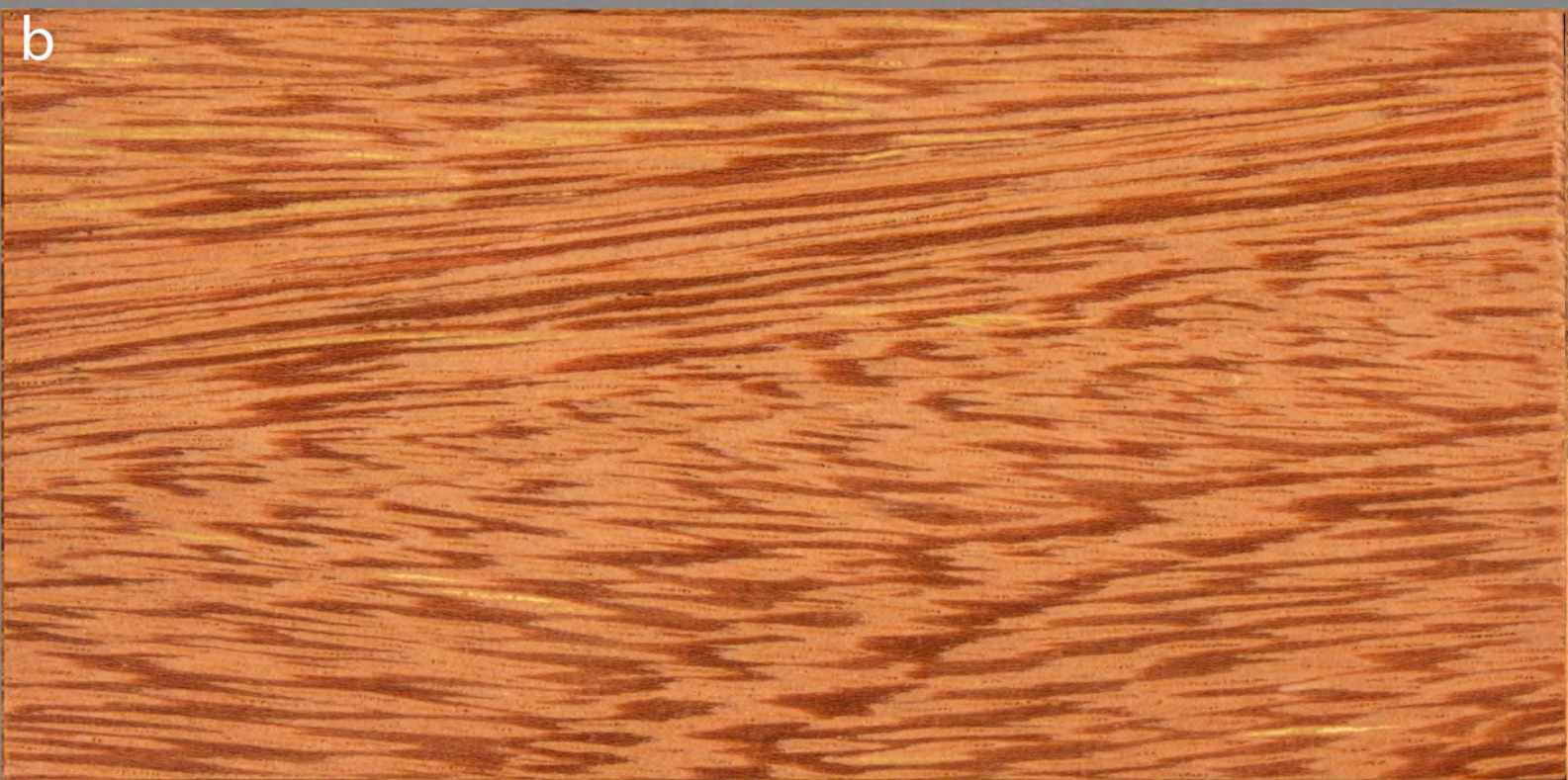
HUAYRURO. ( Ormosia ciccinea .) a).- corte radial. b).- corte longitudinal. c).- corte transversal.
