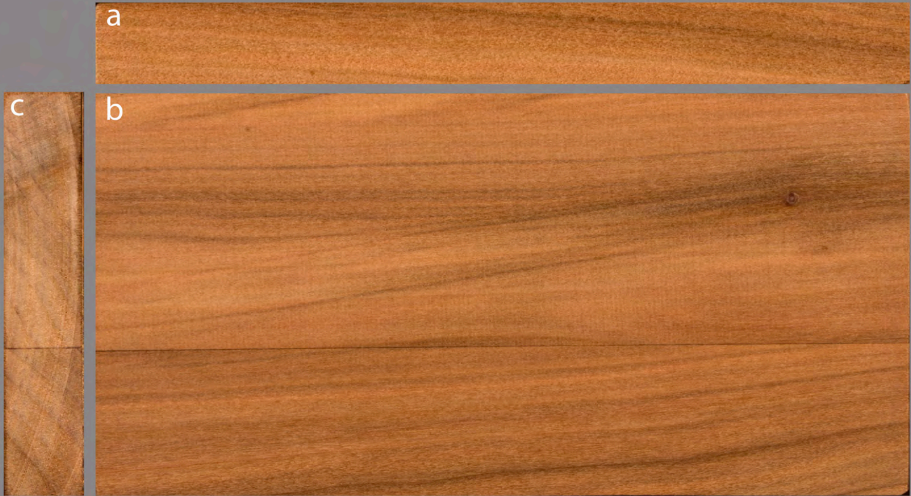
LIQUIDAMBAR. ( Liquidambar styraciflua .) a).- corte radial. b).- corte longitudinal. c).- corte transversal.
