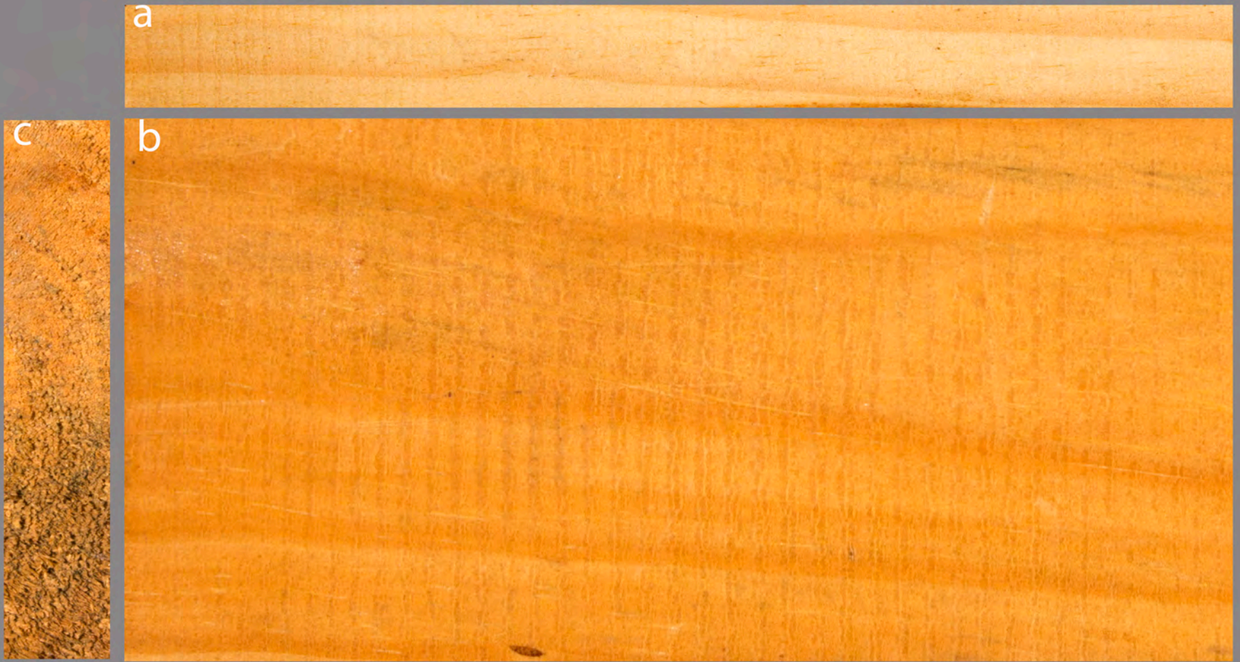
PIPINO BLANCO. ( Pinus arizonica engelm.) a).- corte radial. b).- corte longitudinal. c).- corte transversal.
