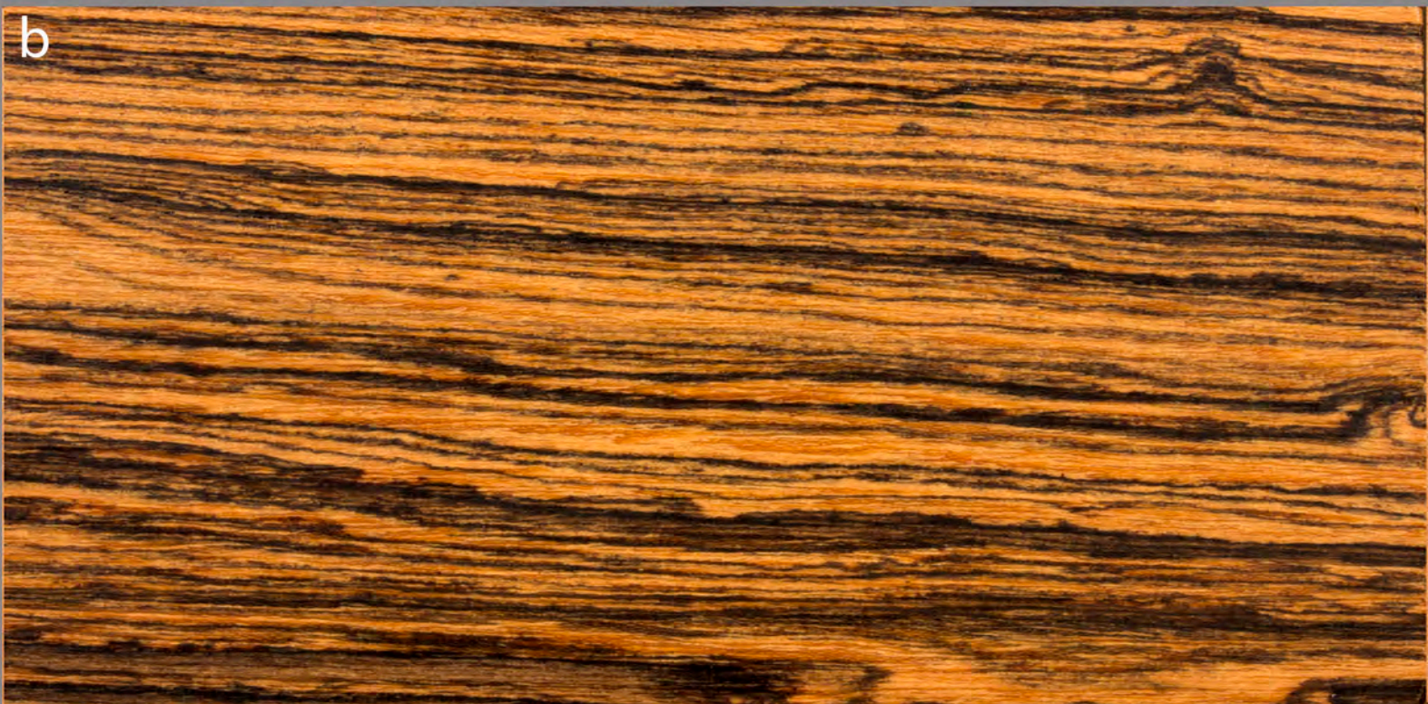
CUERAMO. ( Cordia elaeagnoides .) a).- corte radial. b).- corte longitudinal. c).- corte transversal.
