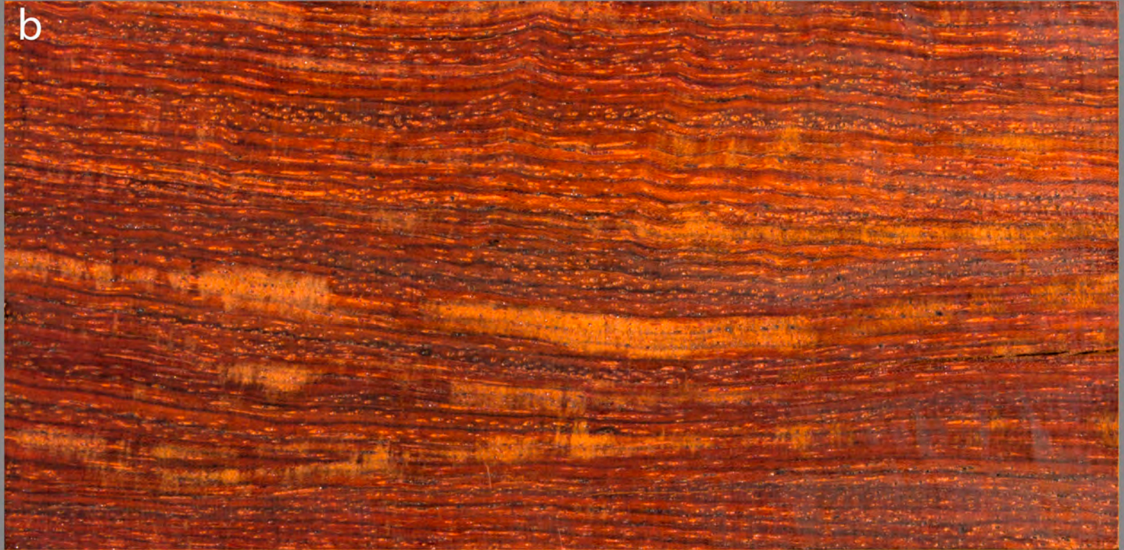
ZANGALICUA. ( Dalbergia granadillo .) a).- corte radial. b).- corte longitudinal. c).- corte transversal.
