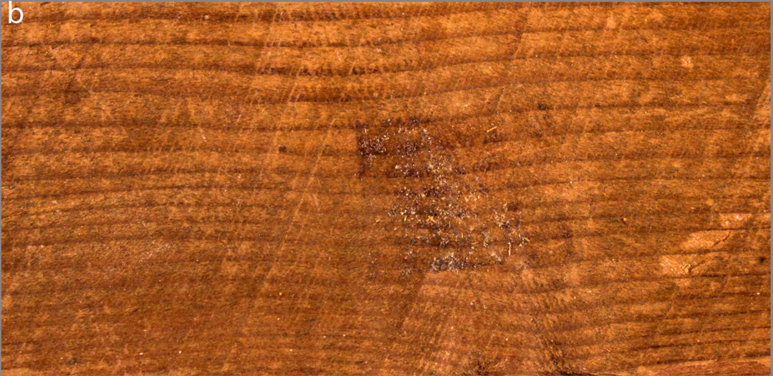
SECUOYA.( Sequoia sempervirens .) a).- corte radial. b).- corte longitudinal. c).- corte transversal.
