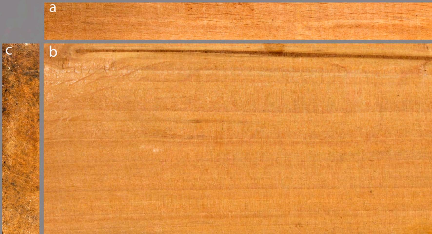
CARNERO. ( Arbutus xalapensis .) a).- corte radial. b).- corte longitudinal. c).- corte transversal.
