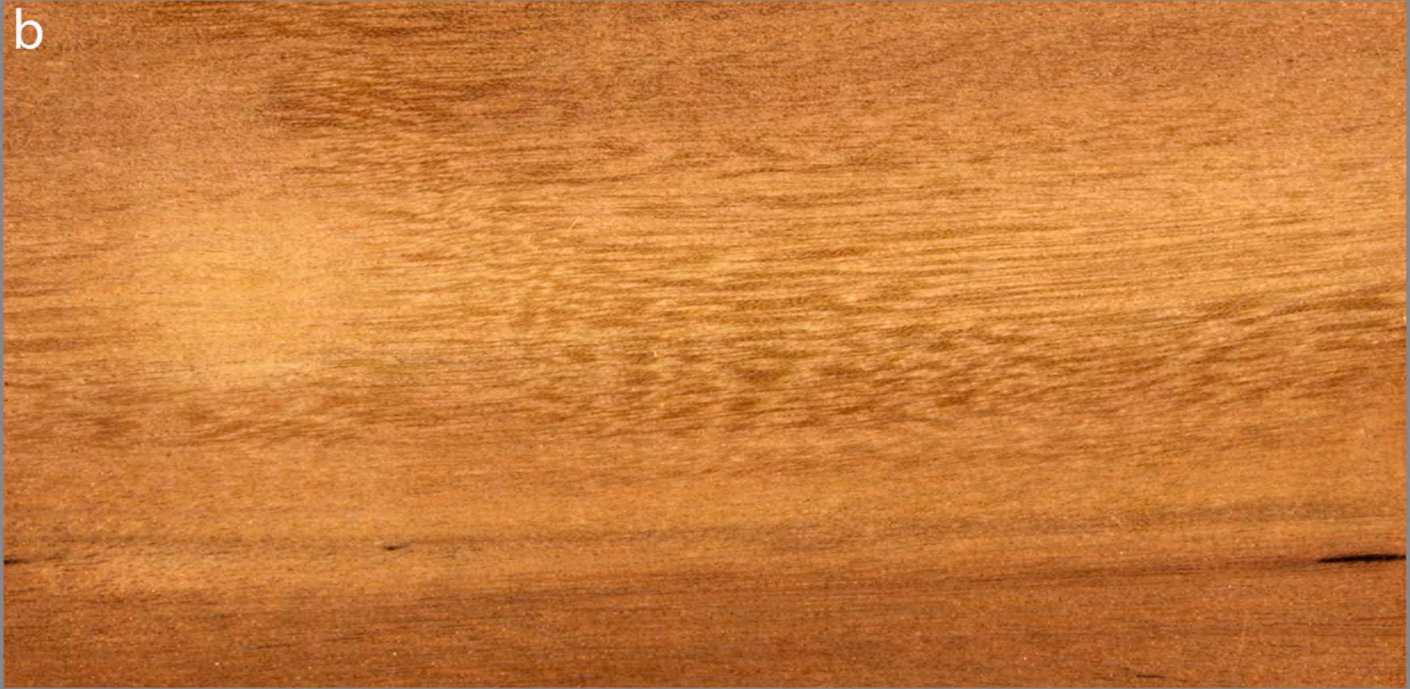
ZACOCOTE. ( Licaria exels. ) a).- corte radial. b).- corte longitudinal. c).- corte transversal.
