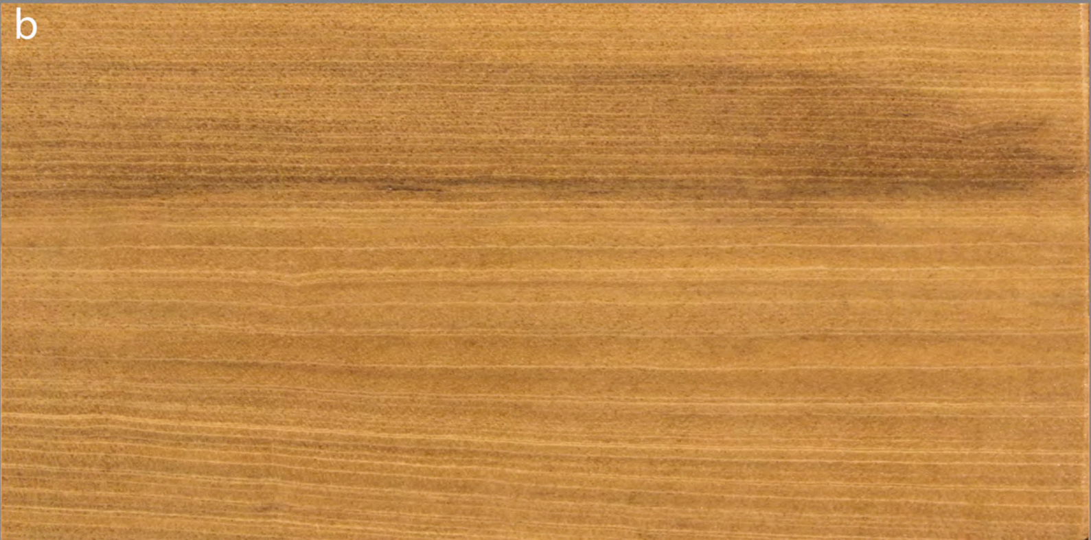
MAGNOLIA- ( magnolia grandiflora .) a).- corte radial. b).- corte longitudinal. c).- corte transversal.
