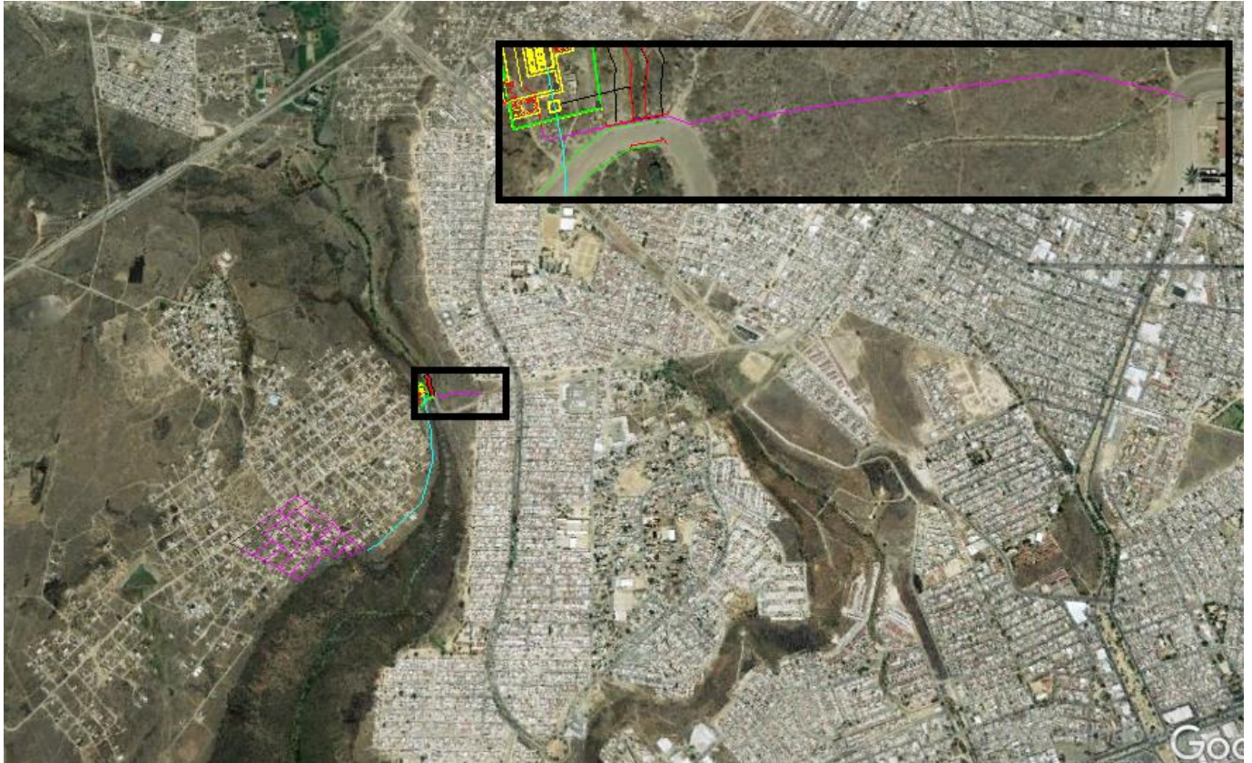
Imagen 10 Trazo de línea de conducción de cárcamo de bombeo a red municipal existente en la colonia León II.
