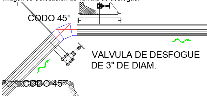
Imagen 33 Colocación de válvula de desfogue.
