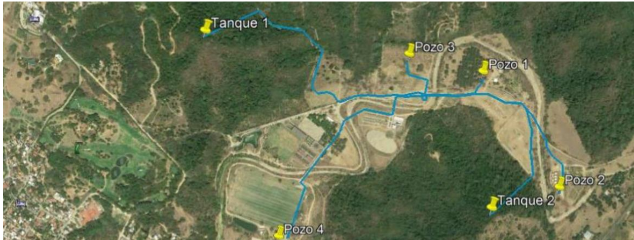
Figura 47. Red de distribución de agua potable
