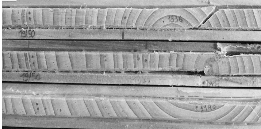
Hình 2.8. Mẫu lõi gỗ khoan đã được dán, đánh bóng và định tuổi chéo
