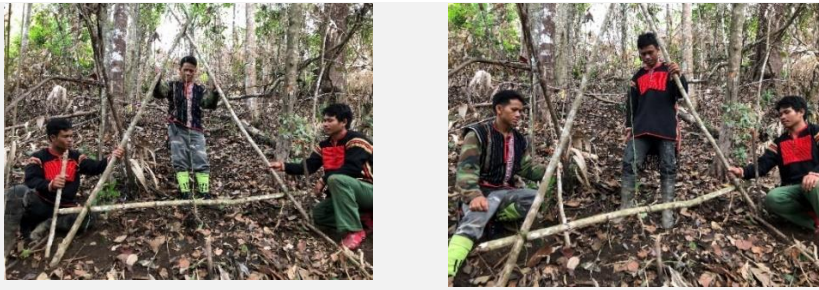
Hình 33. Làm thước chữ A và sử dụng để thiết kế băng chặt theo đường đồng mức
