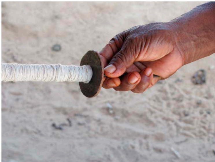
Figura 82: Fuso para fiar algodão, feito de madeira e cerâmica, 2010. Foto: Jean-Jacques Vidal.
