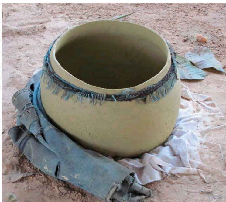
Figura 53: Amarração da borda da peça com pano ou fibra para não perder a forma, 2010. Foto: Jean-Jacques Vidal.
