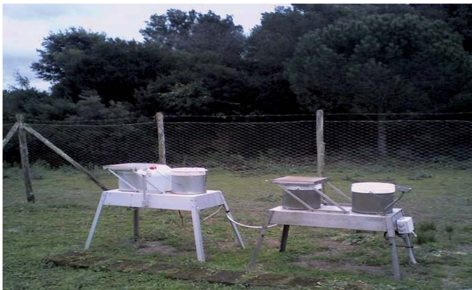
Foto 1. Campionatori per le deposizioni atmosferiche tipo DDAS e Wet&Dry installati in località Tor Paterno.
