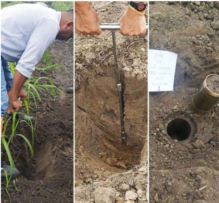
Figura 18. Muestreo de suelos y densidad aparente a diferentes profundidades en suelos con historial de aplicaciones de vinaza en el ingenio San Carlos. CINCAE, 2020.
