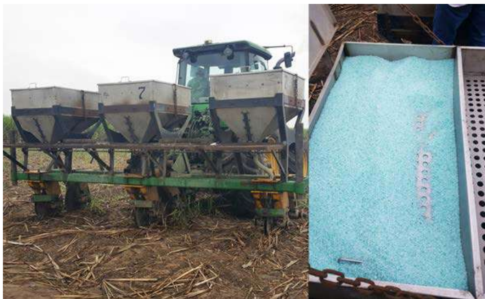
Figura 7. Aplicación mecanizada de fuentes de fertilizante nitrogenado en canteros del tercer tercio de zafra. Ingenio San Carlos, 2020.
