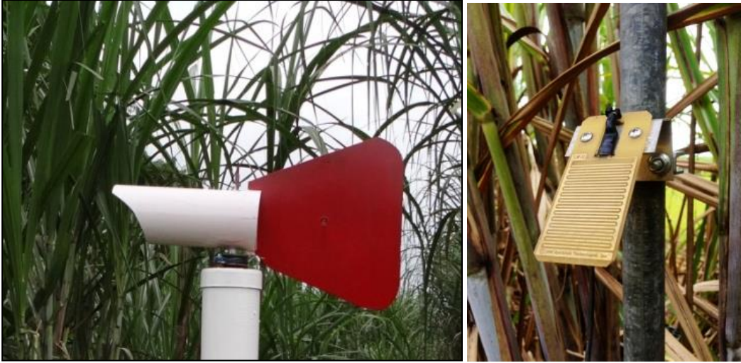
Figura 4. Trampa pasiva para la captura de esporas de roya naranja, Puccinia kuehnii (Izq.), y sensor para la lectura de la lámina de agua en la hoja (Der.). CINCAE, 2012.
