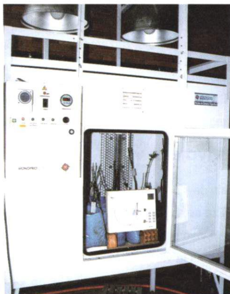
Fig. 2: Câmara de termoterapia, lâmpadas de vapor de mercúrio (topo); placas de irradiação de calor (interior) com sistema de exaustão de ar.
