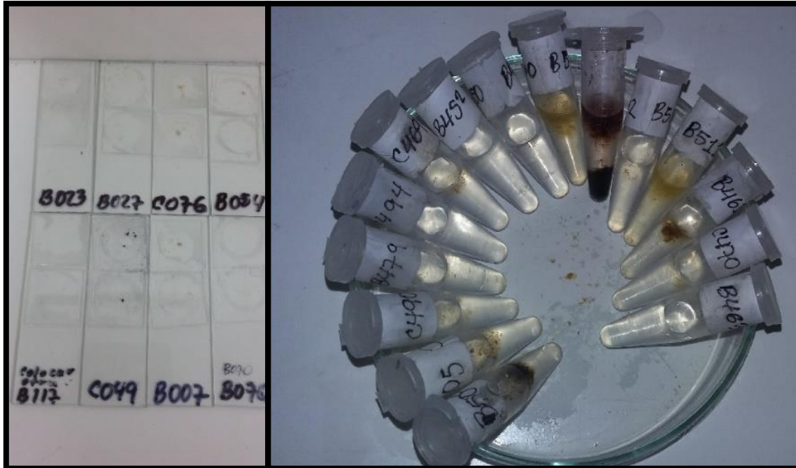
Figura 2-2 (Derecha) Tubos Eppendorf con muestras de polen durante el proceso de Acetolisis; (Izquierda) placa final sellada con parafina y portadora de los granos de polen.
