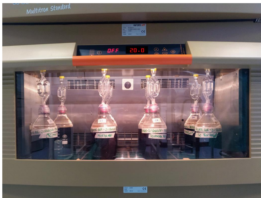
Figura 41. Fermentación a escala de laboratorio en estático a 20 °C. Cada fermentador está provisto de un airlock para permitir la salida de CO 2 y retener la capa de espuma.
