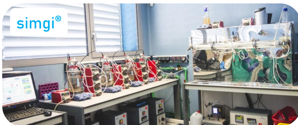
Figura 44. SIMulador dinámico del tracto GastroIntestinal simgi®
