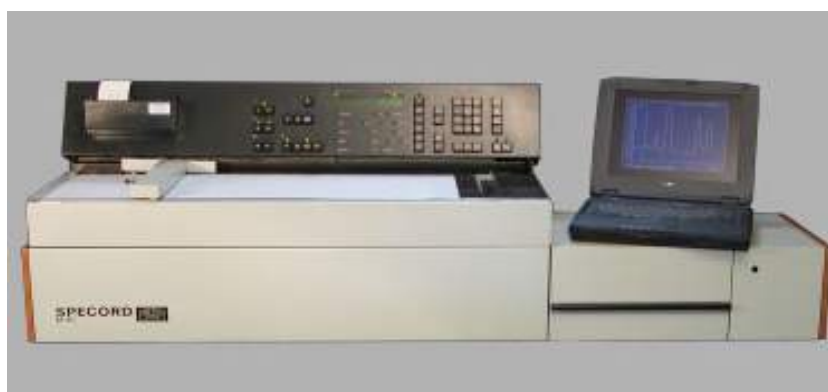
Rys. 4. Urządzenie SPECORD M40 użyte do analizy widm emisyjnych odbitego promieniowania elektromagnetycznego [ http://www.medson.pl ]
