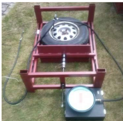
Rys. 6. Urządzenie służące do wyznaczania sztywności promieniowej opon samochodowych wraz z o urządzeniami pomiarowymi
