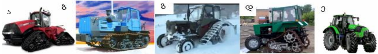
სურ. 1. ტრაქტორები ურთიერთ განსხვავებული სავალი ნაწილით: ა-ოთხი მუხლუხა სავალი ნაწილით, ბ-მუხლუხა, გ,დ-ნახევრადმუხლუხა, ე-თვლიანი.
