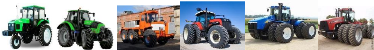
სურ. 2. თვლიანი ტრაქტორები სხვადასხვა რაოდენობის სავალი თვლებით გ-3 თვლიანი, ზ-4 თვლიანი; თ, ი- 6 თვლიანი, კ- 8 თვლიანი, ლ-12 თვლიანი.
