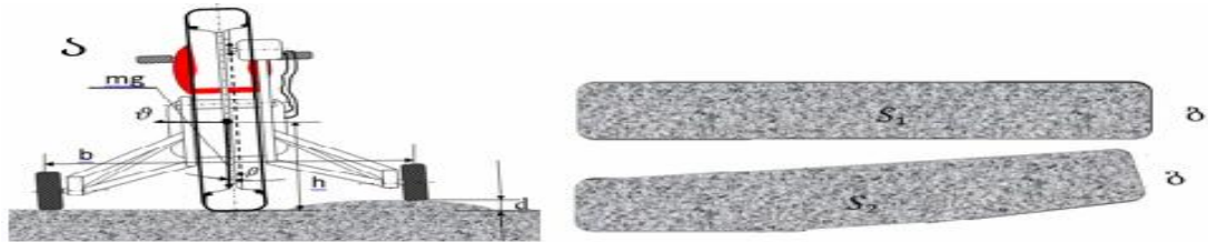
სურ. 7. ა-ტრაქტორზე გვერდითი შეშფოთებისას მოქმედი ძალების სქემა, ბ-„ტრაქტორის“ წრფივი მოძრაობისას, საყრდენი წარმოსახვითი Si სიბრტყის ფორმა; გ-„ტრაქტორის“ მანევრირებისას, საყრდენი წარმოსახვითი Si სიბრტყის ფორმა;
