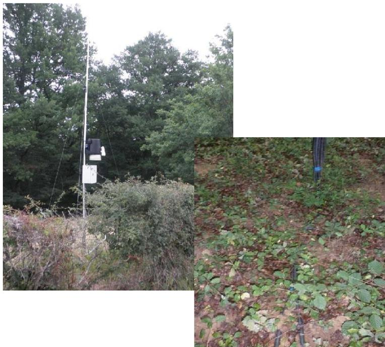
Fig.2 et 3 –Station météorologique en bordure de placette. Câbles reliant une station relais et des sondes tensiométriques placées dans les premiers horizons de sol.
