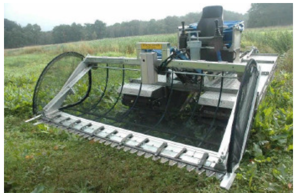
Abb. 69: Amphibien-Fahrzeug Truxor ( www.doroteamekaniska.se , 07.07.2010).
