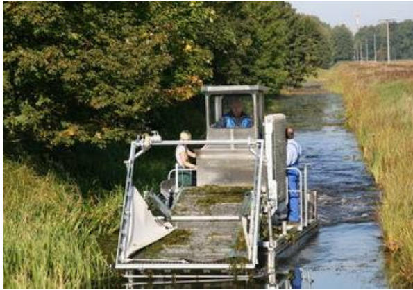
Abb. 66: Mähsammelboot mit seitlichem Mähgutaustrag ( www.tyroller-hz.de ; 07.07.2010)
