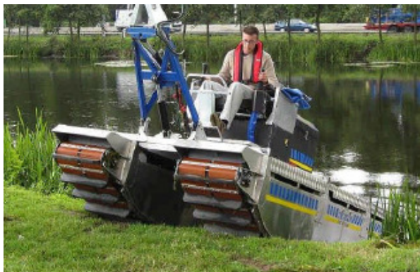
Abb. 70: Truxor mit Schneidgerät DOROCUTTER ESM 2200 (ebd.).
