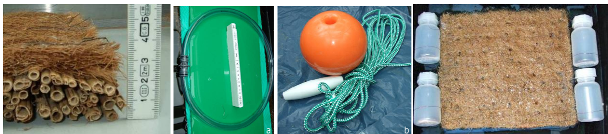
Abb. 8: Nachwachsende/recyclebare Materialien und Kunststoff-Hohlkörper (v. li n. re): Schilf mit Kokosauflage, PE-Schlauch mit Muffe, Float U70 für Berufsfischerei, Plastik-Flaschen.
