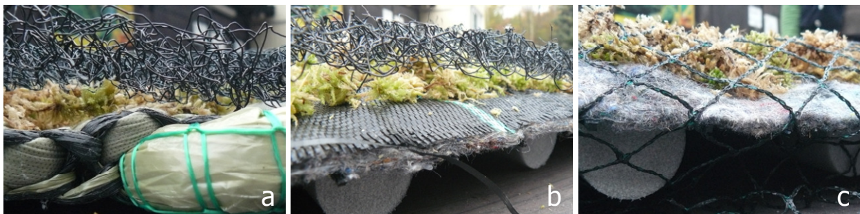
Abb. 34: Detailansichten von eingerichteten Matten für den Torfmoosversuch im E-Moor: a) C4-Matte mit S. papillosum ganz und Nylonschlingelege (CKP), b) NB-Matte mit Bändchengewebe, S. palustre ganz und Nylonschlingelege (GBP) und c) N-Matte mit S. papillosum + S. magellanicum ganz und Vogelnetz (GNM).
