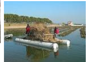
Abb. 68: Katamaran zur Pflege von schwimmenden Röhrichtmatten ( www.bestmann-green-systems.de ; 07.07.2010).
