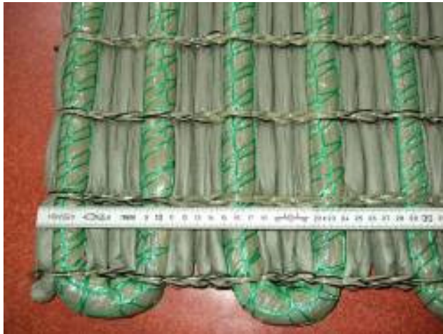
Abb. 5: Kettengewirkte patentierte Matte (von stfi) mit ummanteltem PE-Schaumseil als integriertem Schwimmkörper (getestet im Projekt als Mattenvariante C4).
