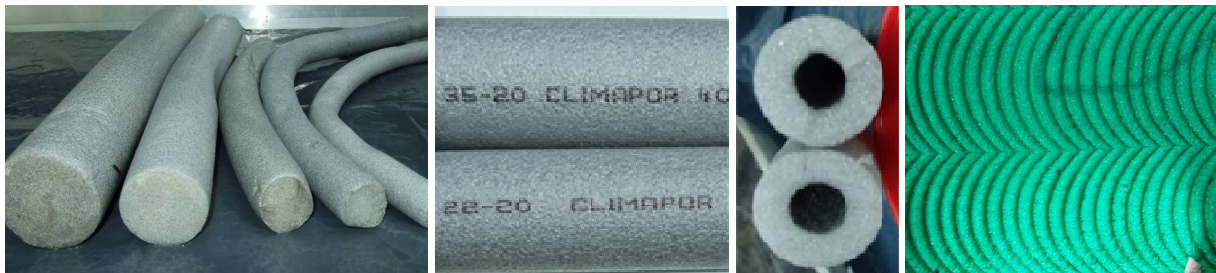
Abb. 6: PE-Schaumstoffe weich (v.li n. re): Baustoffrohr (BOSIG), Isolationsrohr (Climapor): längs und Querschnitt, Camping-Iso-Matte.
