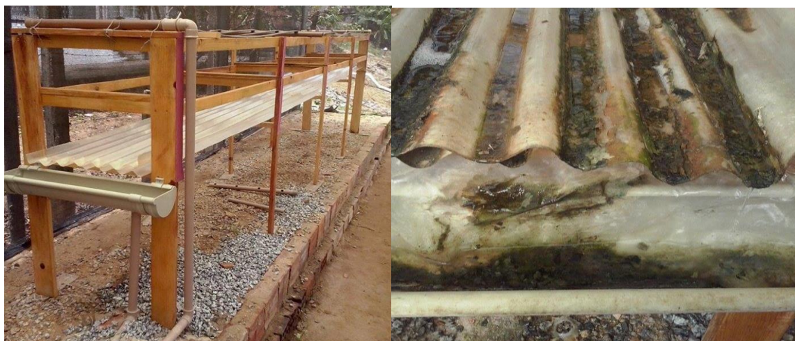
Figura 1. Imagem da bancada experimental antes do uso e após 600 horas de uso com água residuária.
