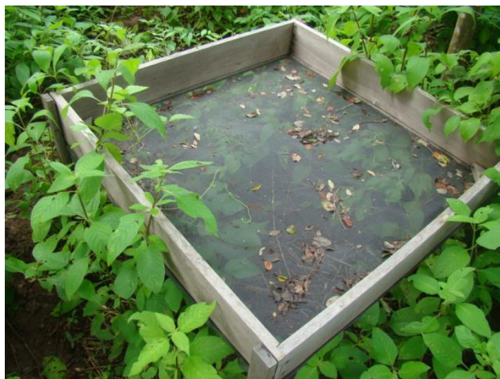
Figura 2. Caixa coletora de serrapilheira na Bacia Experimental de Iguatu - BEI.
