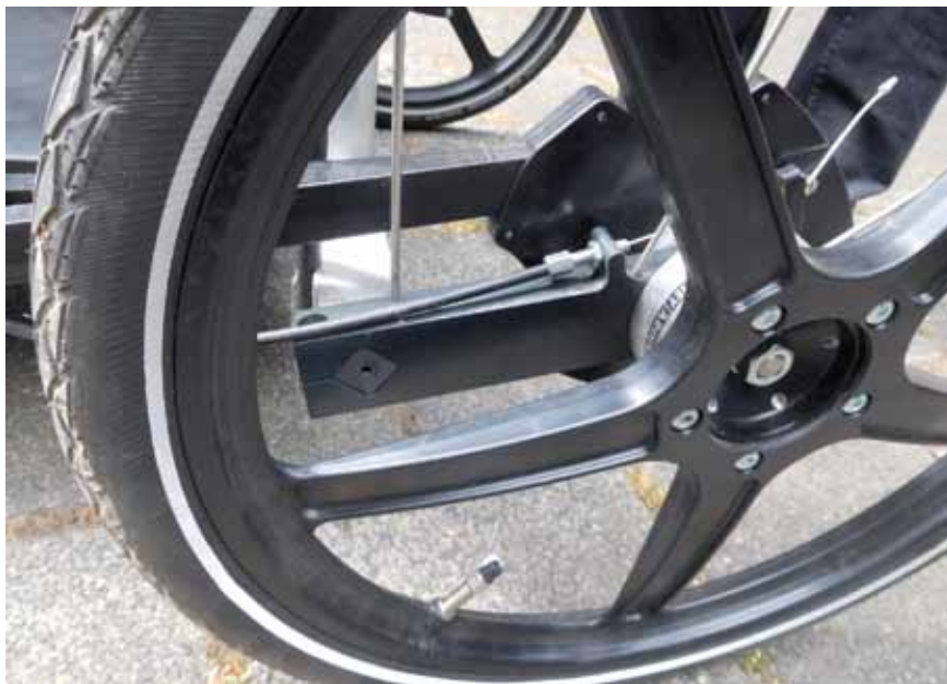
Torsie-as met riemtrommel.
