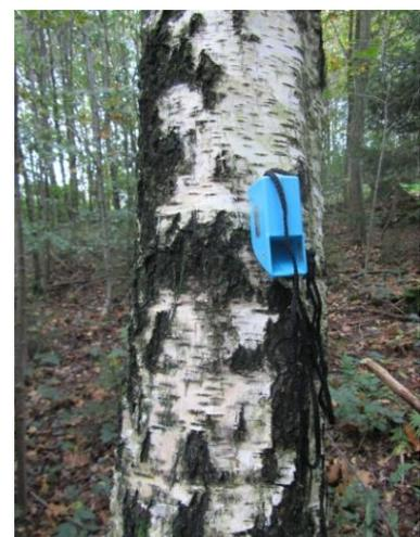
Abbildung 14 Transponder des VERTEX im Einsatz für die Baumhöhenmessung.
