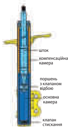
Амортизатор гідравлічний
