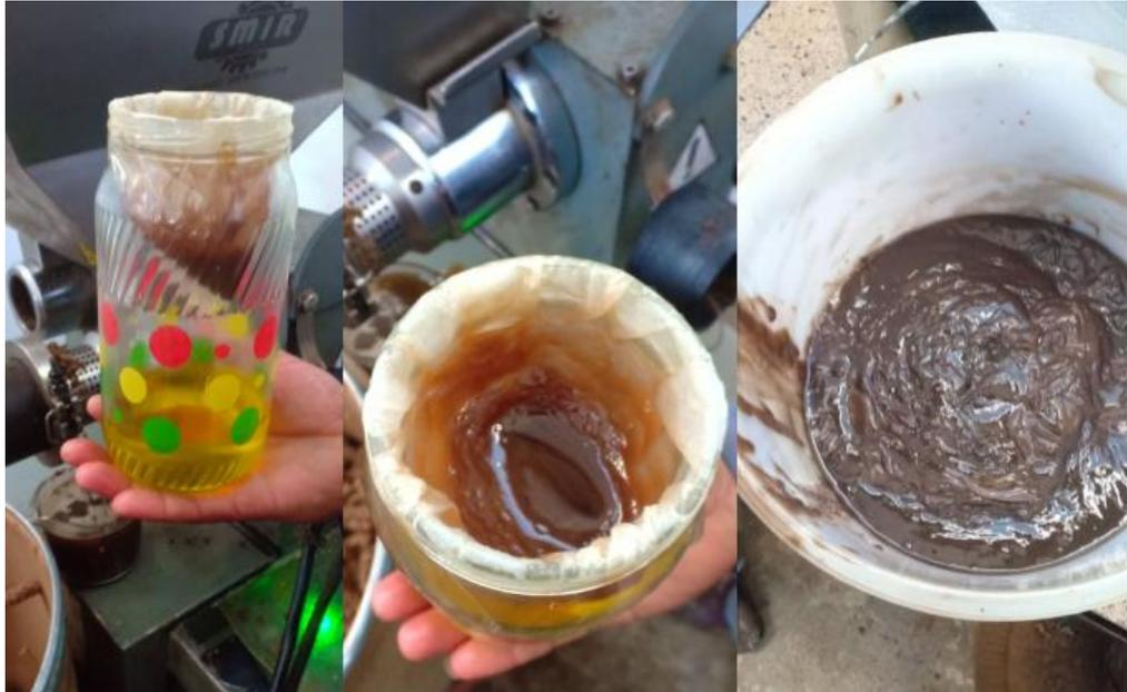
**Photo 23 : Filtrage et collection de graisse d'huile de figue de barbarie. Photos prise au niveau de l'usine de transformation de la figue de barbarie NOPALTEC, de Sidi Fredj, Souk Ahras, 2019 (01 Janvier 2019).**
