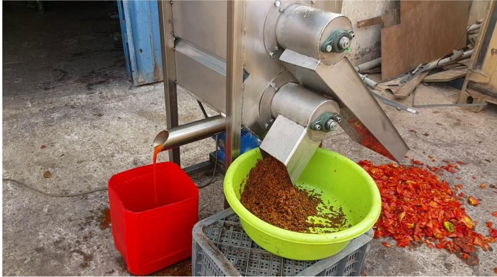
**Photo 20 : Machine de séparation des grains de figue de barbarie (SMIR, 2016)**
